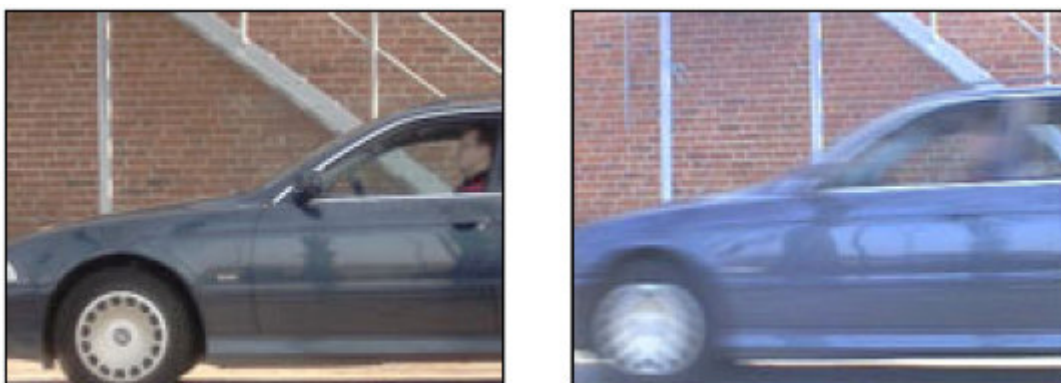
Fig. C.1. Comparativa para captura de un vehículo en movimiento. Cámara con escaneo progresivo a la izquierda. Cámara PAL con escaneo entrelazado a la derecha.
