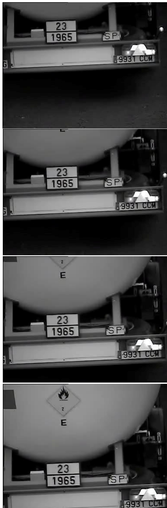
Fig. 1.2. Secuencia de Captura y Detección de una placa identificativa de Mercancías peligrosas
